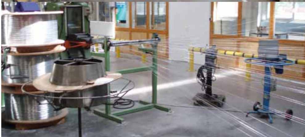
Ovan: Tråddragning. Dyckert och klammer formpressas i stansmaskin.
