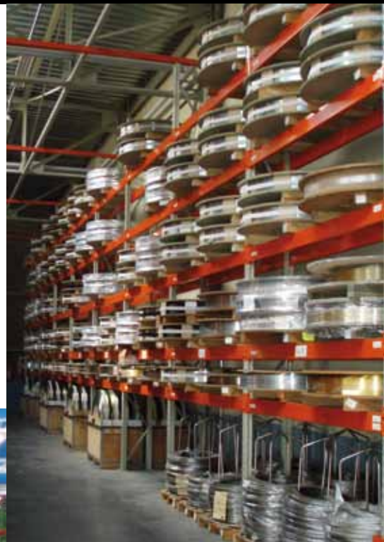
Ovan: Lager med trådrollar. Det finns över 120 artiklar med olika tråddimensioner och material. Rullarna väger mellan 500 och 1400 kg styck.
