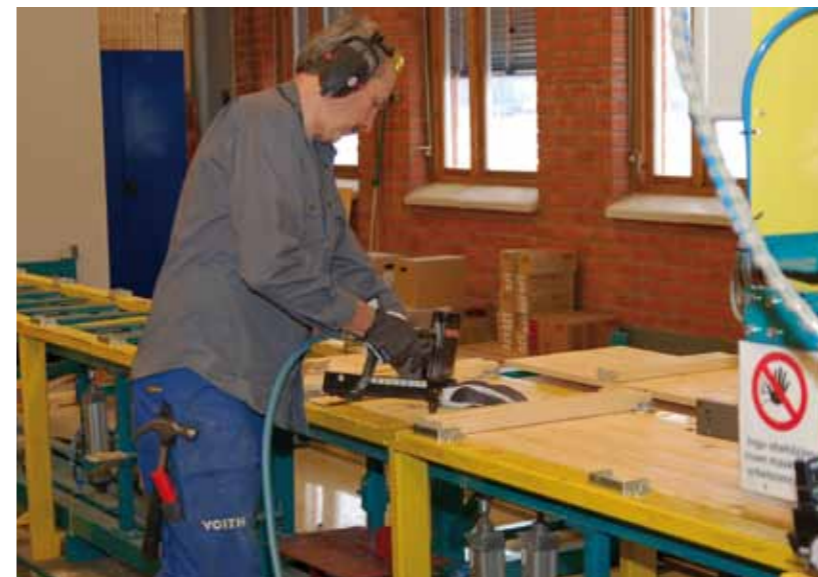
Vänster: Spikning av lådans botten, här med klammerverktyg SLS20.
