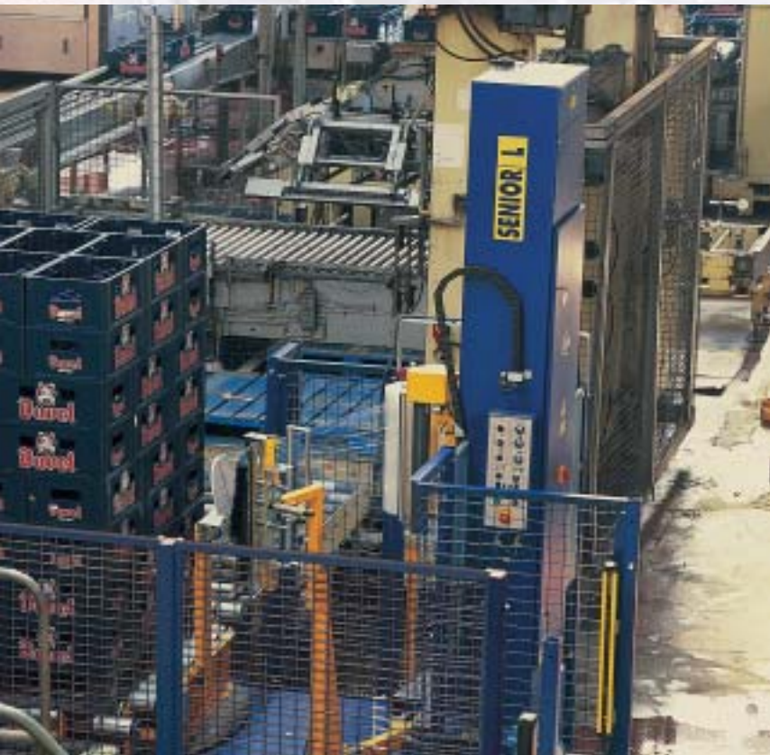
De klem brengt de folie automatisch aan de palet aan
