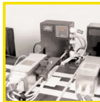
De twee hoge resolutie printkoppen ( 300 dpi ) zorgen voor een kwalitatieve bedrukking op twee verschillende locaties.
