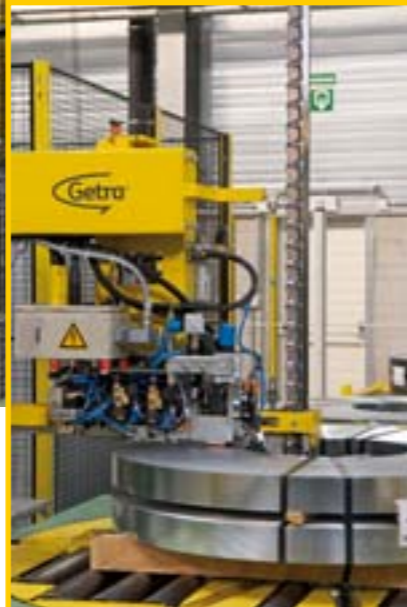
Getra - Titan VS 12 omsnoeringskop met sluiting door las
