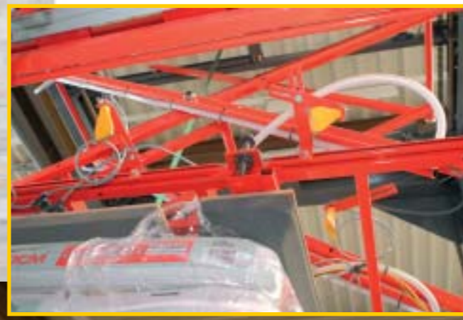
Tijdens de wikkelcyclus houdt de aandrukplaat het dekvel op zijn plaats
