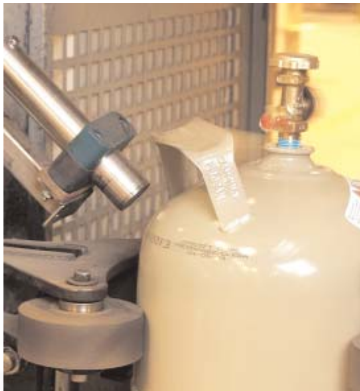
Terwijl de gasfles ronddraait, wordt de code 3 keer geprint
